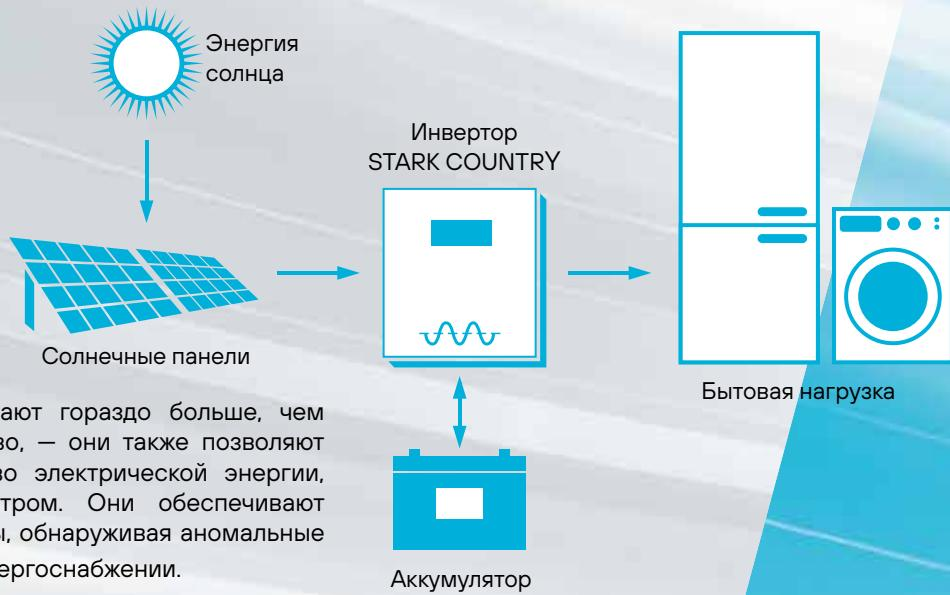
Солнечные инверторы делают гораздо больше, чем просто преобразуют электричество, – они также позволяют извлечь максимальное количество электрической энергии, производимой солнцем или ветром. Они обеспечивают безопасную работу вашей системы, обнаруживая аномальные электрические токи и перебои в энергоснабжении.
