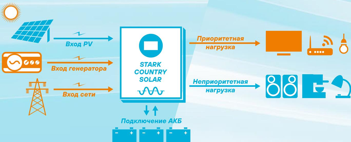
**2 независимых входа** позволяют подключать сеть и генератор к инвертору без использования АВР.
